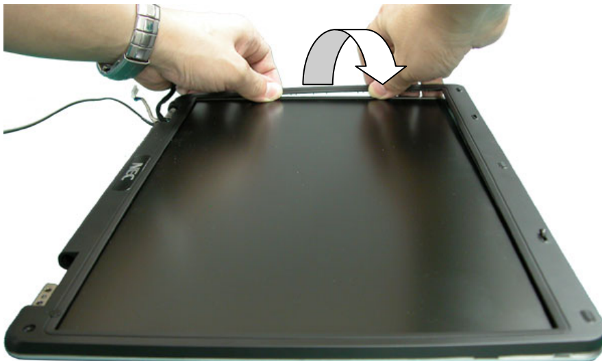
Fig. 26 Removing the LCD Bezel
